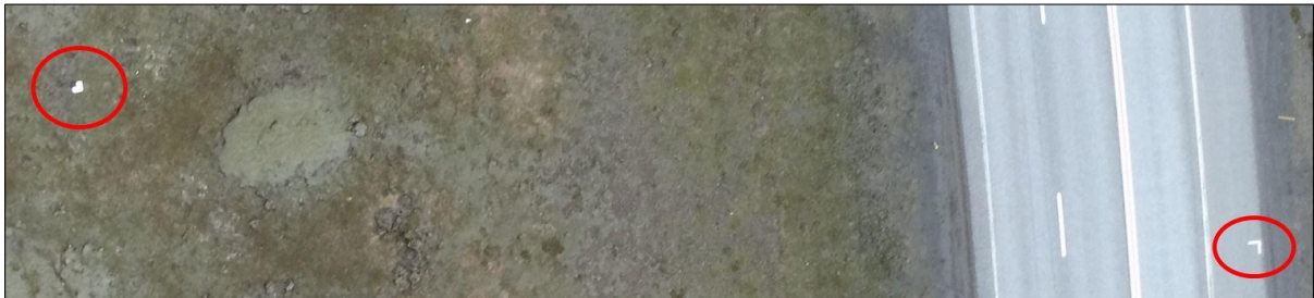
Mynd 4. Tveir „control“ punktar, dúkur vinstra megin á mynd en málaður vinkill í vegöxl hægra megin.
