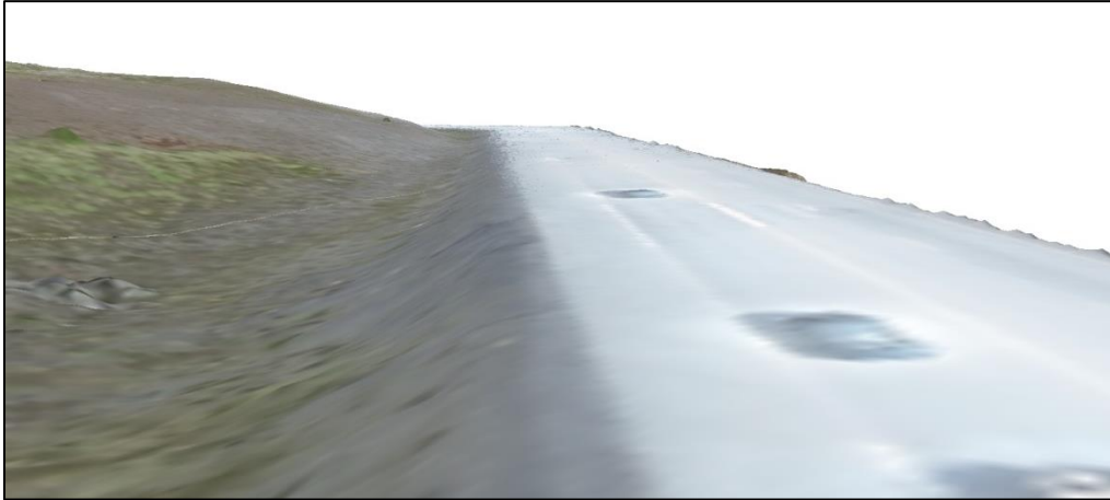
Mynd 13. Þrívíddarmynd af Kömbunum upprétt lofmynd og landlíkan frá Designing Reality. Vegrið er hægra megin við veginn en hugbúnaðurinn nær að hreinsa það út að mestu leiti.
