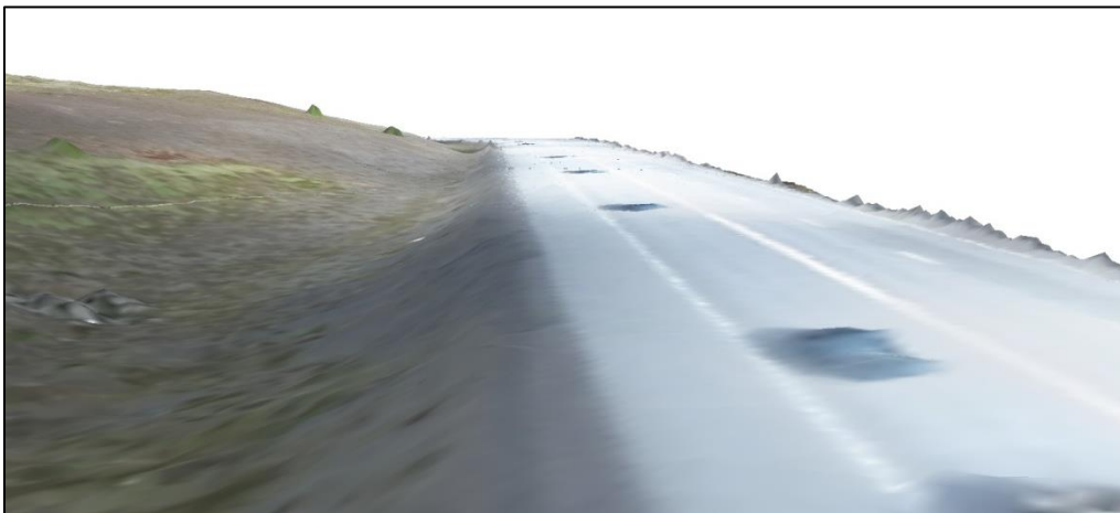
Mynd 14. Þrívíddarmynd af Kömbunum, loftmynd og landlíkan frá Pix4D. Sama sjónarhorn og mynd 12. Á hægri hönd er vegrið sem hugbúnaðurinn hefur hreinsað út að nokkru leiti. Einnig sjást trjárunnar vinstra megin við veg sem ekki koma fram í landlíkani Designing Reality.
